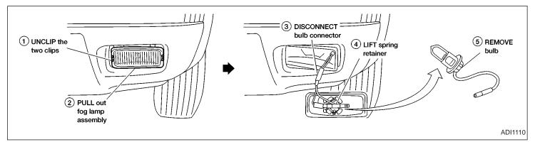
FRONT FOG LIGHT BULB RE-PLACEMENT (if so equipped)
